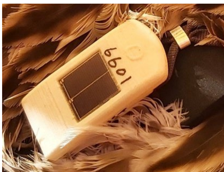
圖 1.4-3 10.5 克的 Debut Flex 衛星發報器(Druid, Inc.)
