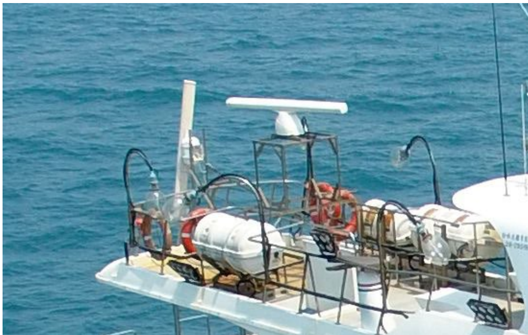
圖 1.4-1 架設於船舶上之雷達天線
