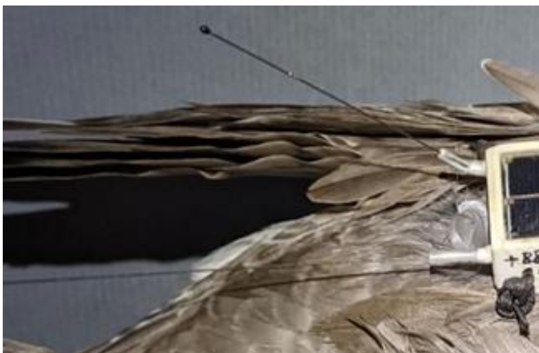
圖 1.4-2 5.8 克的 Debut Mini 衛星發報器(Druid, Inc.)
