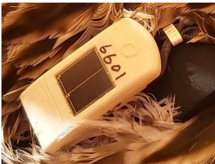
圖 1.4-3 10.5 克的 Debut Flex 衛星發報器(Druid, Inc.)
