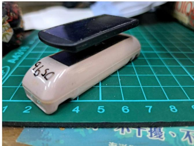
圖 3. 25 克的 Debut Lego 衛星發報器(Druid, Inc.)
