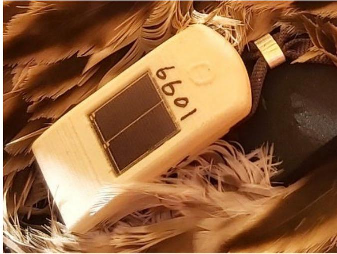
圖 2. 10.5 克的 Debut Flex 衛星發報器(Druid, Inc.)
