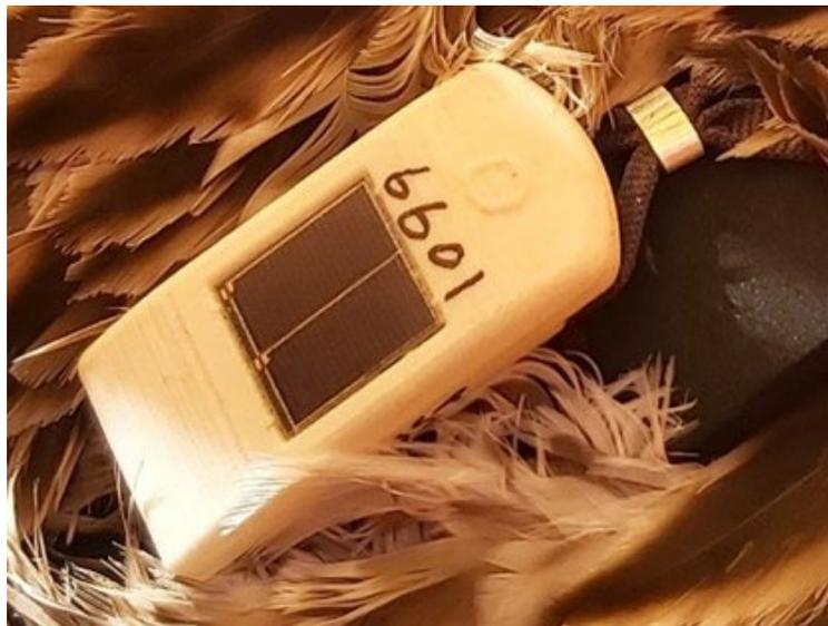
圖 1.4-3 10.5 克的 Debut Flex 衛星發報器(Druid, Inc.)
