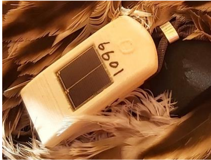
圖 2. 10.5 克的 Debut Flex 衛星發報器(Druid, Inc.)
