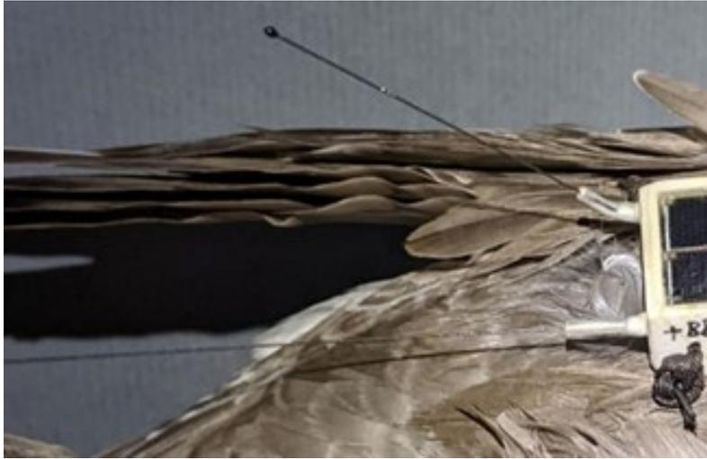
圖 1.4-2 5.8 克的 Debut Mini 衛星發報器(Druid, Inc.)
