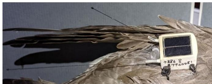
圖 1. 5.8 克的 Debut Mini 衛星發報器(Druid, Inc.)
